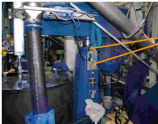
Bild 3: Zweihandsteuerung für die Deckelbewegung
