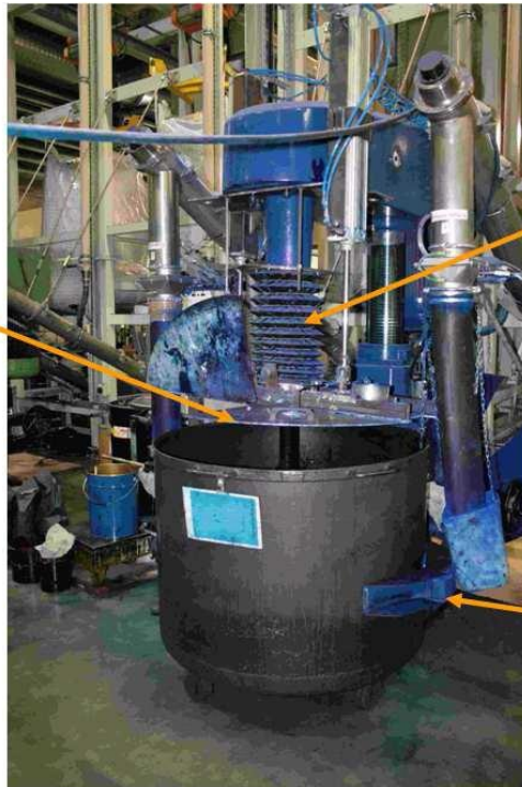
Bild 2: Schutzeinrichtungen für die Rührwelle und das Rührorgan
