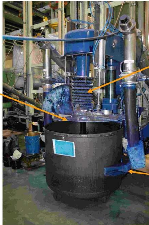
Bild 2: Schutzeinrichtungen für die Rührwelle und das Rührorgan
