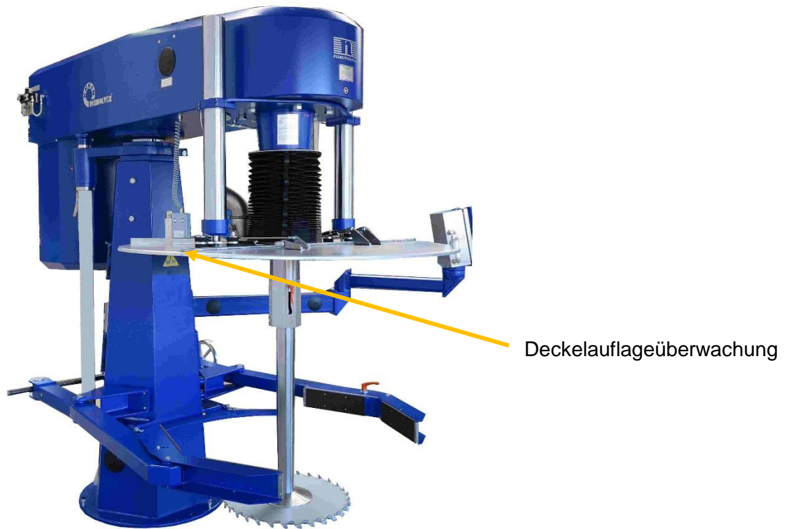
Bild 8: Überwachung der Auflage des Deckels am Mischbehälter durch radial angeordneten Sensor
